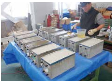
▲ 亜硝酸イオン浸透性試験の供試体作製
