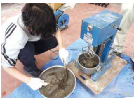
▲ ファインバブル水を用いたモルタル試験
