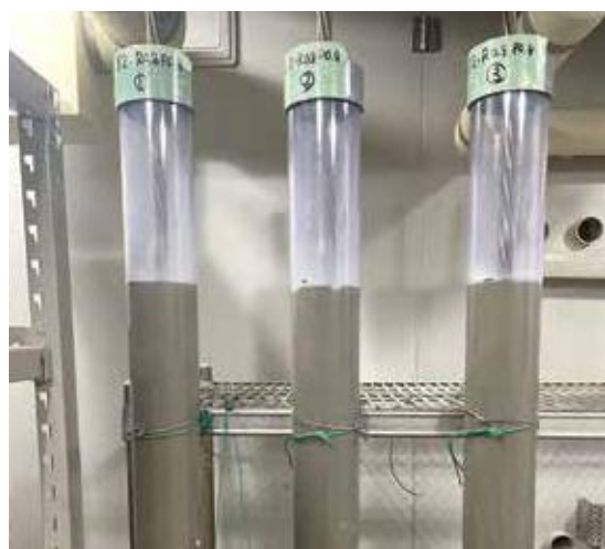
▲写真③ 鉛直管試験(膨張収縮率の測定)
