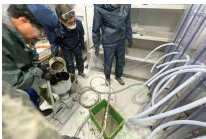
▲写真② 鉛直管試験(充填作業)
