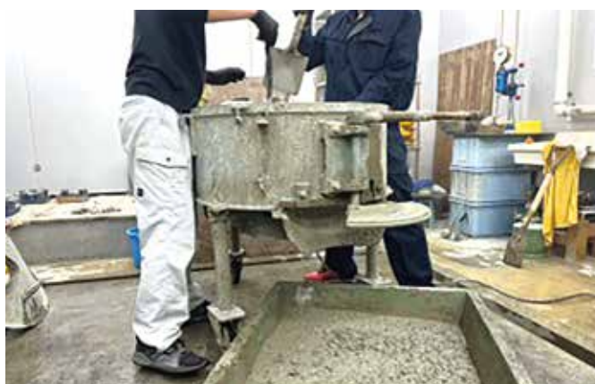
▲写真① コンクリートの練混ぜ
