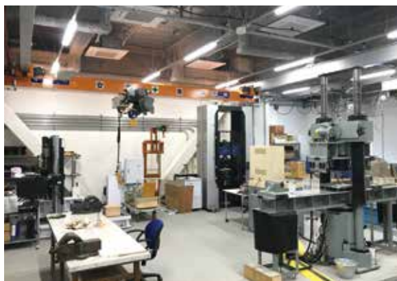
▲ 新しく導入された機器 (左から疲労試験機、万能試験機、曲げ載荷付き圧縮試験機)
