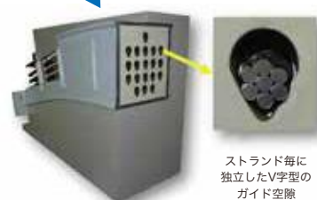
▲ 図-3 SSIサドル(カットモデル)
