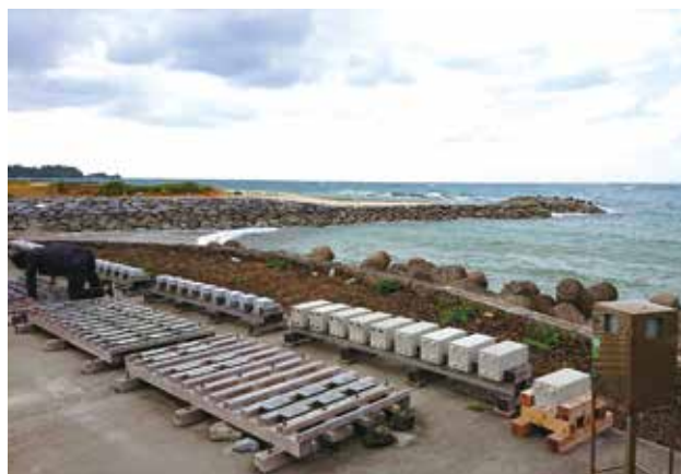
▲ 沖縄でのジオポリマー曝露試験状況
