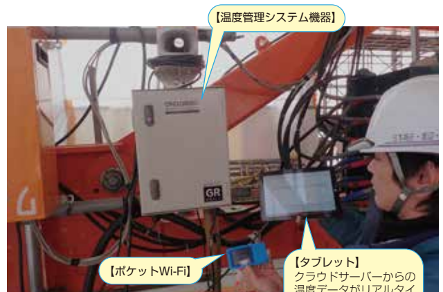
▲ モバイル式養生温度管理システム (主桁の計測温度はシステム機器に無線で転送)
