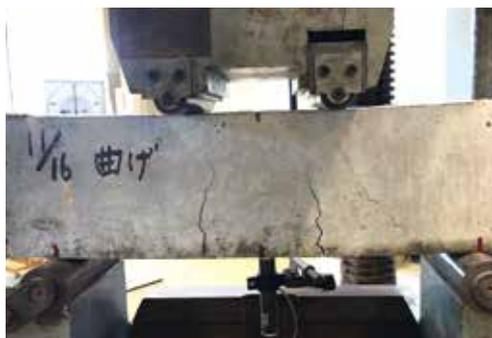
RCはり供試体の曲げ載荷実験
