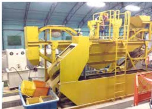
世界初パルスパワー技術による再生骨材製造プラント Pulsar-Mk. I
