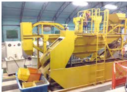
世界初パルスパワー技術による再生骨材製造プラント Pulsar-Mk. I
