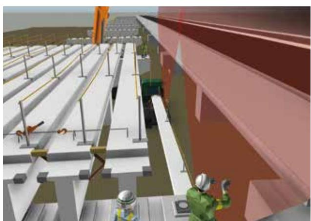
▲ 3Dモデルによる架設作業の可視化
