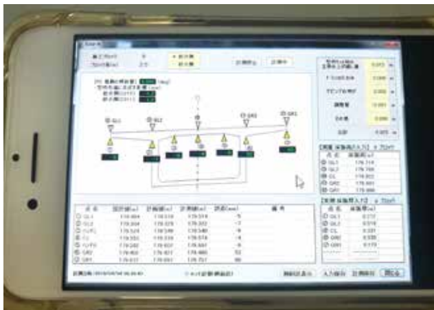
▲ ICT活用状況 (タブレット端末での型枠高さ表示)
