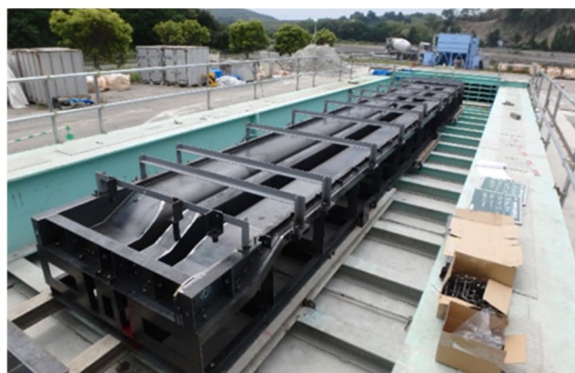
写真－６ 転用されたPCaDT板の鋼製型枠
