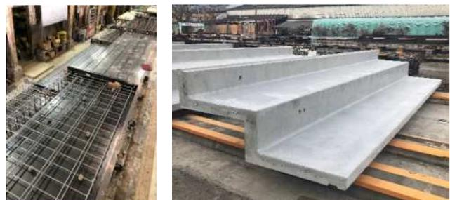
写真-14 PC 段床版製作状況
