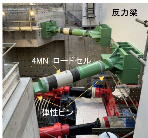
(a) V型に配置された荷重計測リンク
