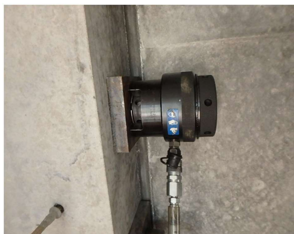
写真12 ボルトテンショナー
