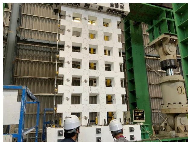
写真-10 SPC 格子壁 実大実験状況
