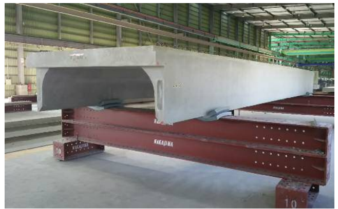
写真-9 脱型後の製品状況
