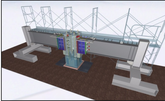
図 12 BIMによる実験計画の検討
