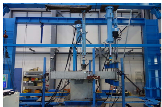
写真-9 試験体および荷装置
