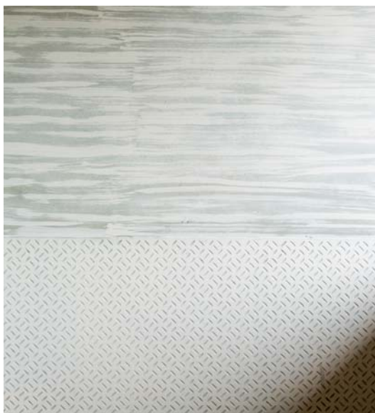
写真4 縞鋼板の模様
