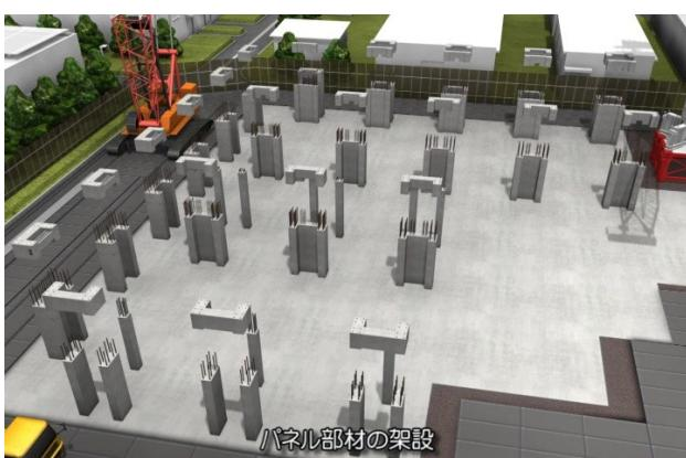
STEP3:パネル部材の架設
