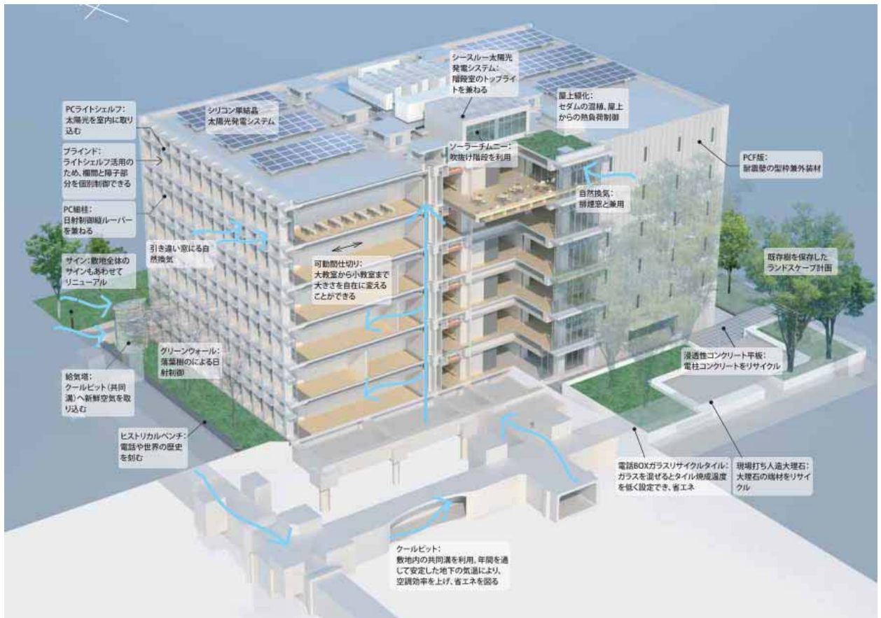
環境施策図：既存共同溝を利用したクールピットなど
