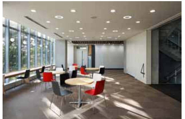
リフレッシュスペース：自然換気窓から給気 LED照明を採用
