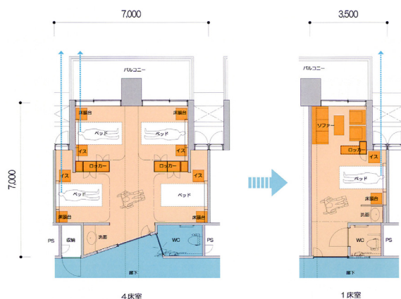
4床室から個室への改修
