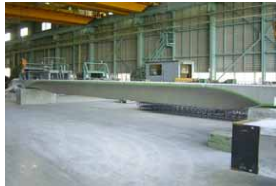
fig.9: 脱型直後のPC床版
