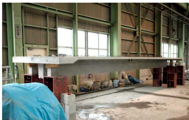
fig.8: 脱型した PC 床板
