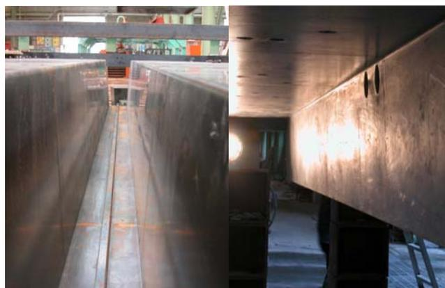
左 fig9 : 金属型枠の内側—補強リブの溶接跡が現れている。
