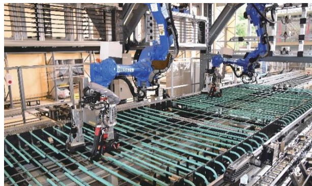
PC床版の鉄筋組立自動化システム
