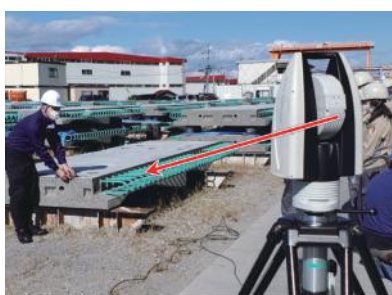
プレキャスト部材寸法の自動計測
