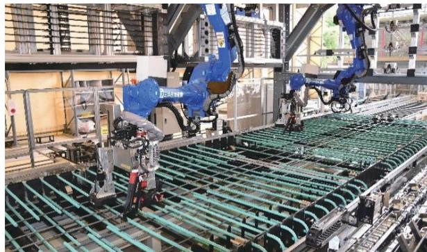
PC床版の鉄筋組立自動化システム
