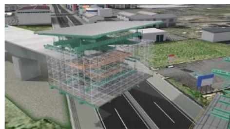
BIM/CIM 幹線道路を交差する張出し施工モデル
