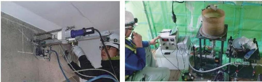
既設構造部への削孔を最小限にしたシーす内の空洞量測定システム
