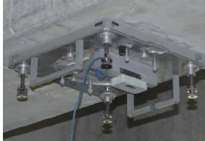
写真-2 全視野ひずみの測定(切削前後)
