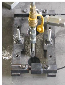
写真-1 切断およびフラットジャッキ配置状況
