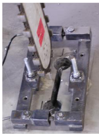
写真-1 切断およびフラットジャッキ配置状況
