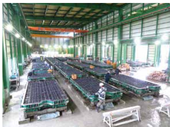
▲ 軌道スラブ製作建屋内
