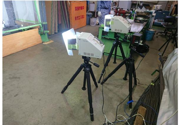
写真-6 高速度カメラ配置状況
