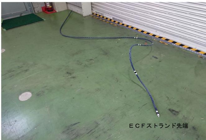
破断射出後のPC鋼材
