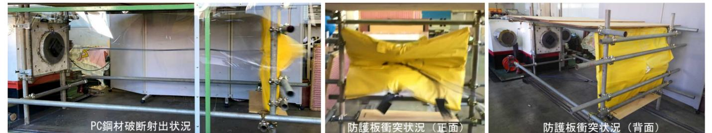
写真-1 射出実験状況の一例（NO.4 パターン2[2回目]）
