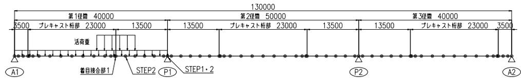
STEP1... = 2.5 P1 支点の上縁にて鋼材が第 1 降伏点を超える。
