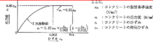
図-5.8.1 コンクリートの応力度-ひずみ曲線
