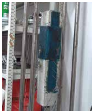
▲ BFRPシートの付着強さの測定
