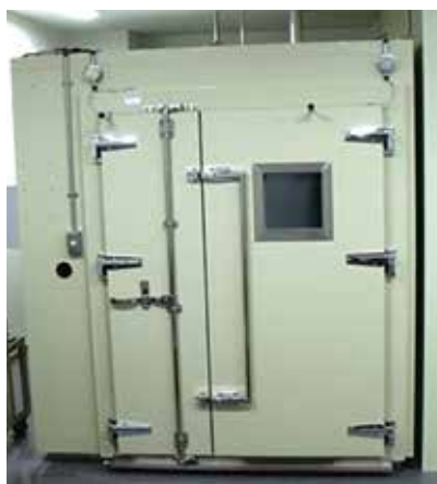
▲恒温恒湿室外観
