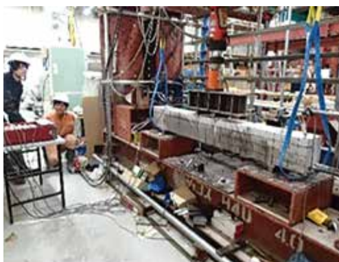
▲ DEFを受けたRCはりの載荷試験
