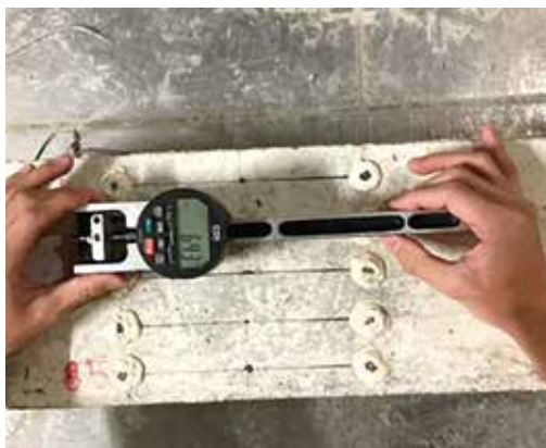
▲ DEFを受けたRCはりの膨張量測定
