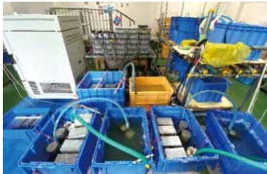
▲写真3 コンクリート供試体を用いた乾湿繰り返し実験
