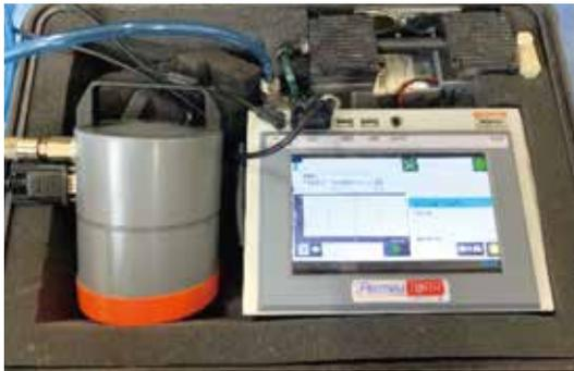
▲写真1 透気試験(トレント法)による品質評価
