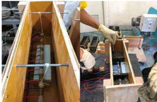
▲写真2 分割鉄筋を埋設したコンクリート供試体の作製
