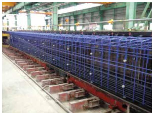
▲ エポキシ樹脂で被覆したPC鋼材と鉄筋を使用したプレテンションT桁
