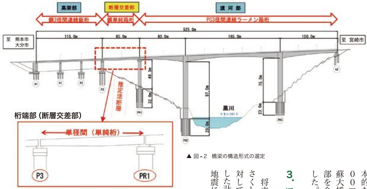
▲ 図-2 橋梁の構造形式の選定
