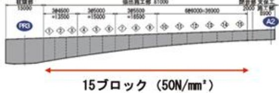
▲図-5 主桁ブロック割りの比較
