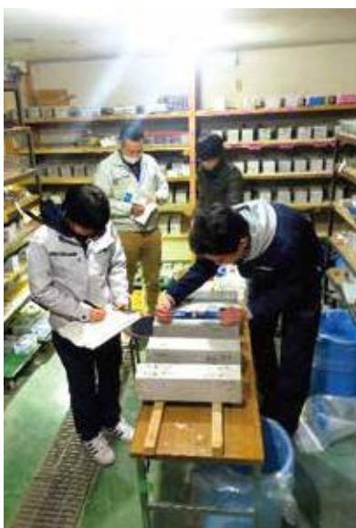
▲写真-4 乾燥収縮の測定を行う恒温恒湿度室
