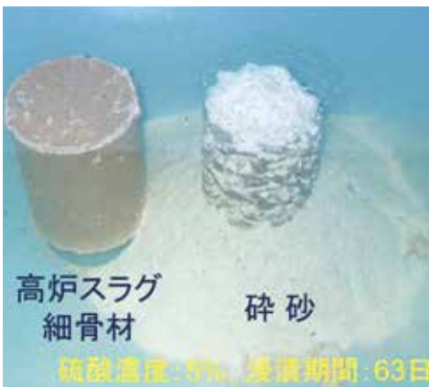
▲写真-2 高炉スラグ細骨材コンクリートの耐硫酸性
