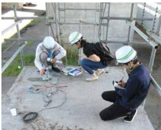
▲コンクリート中の鉄筋の腐食診断
