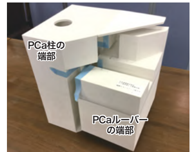
▲写真-5:端部接合部の実寸模型
