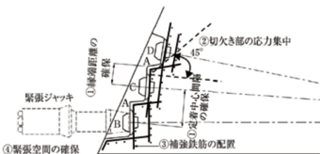
図3 斜角を有する部材に定着する場合の安全性に配慮した事例 (道路橋示方書 平成29年版 III編 p.111 図-解5.3.14)
