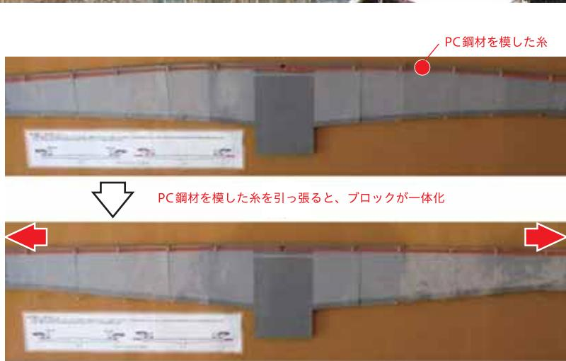
PC鋼材引張による桁の変形を模擬した模型図の活用～現場見学会
