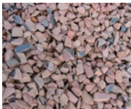
廃瓦を小さく砕いた状態
