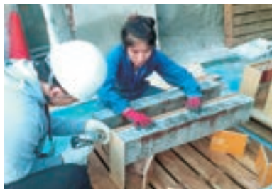
写真-4 吹き付けのための供試体作製
