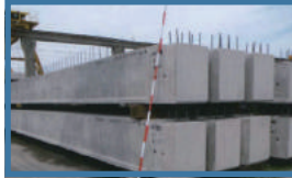
JIS桁 (7°レテンションホロ-桁) 品質の行き届いたJIS工場で製作。クレーン、架設桁等によって桁架設を行い、間詰め部を現場にて施工する。⇒作業性、品質向上。
