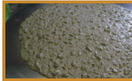
締り込み不要コンクリート (高流動コンクリート) 型枠に流し込むだけで、材料分離することなく充填されるコンクリート。コンクリート打設時の振動締固め作業が不要。⇒現場作業の省力化。
