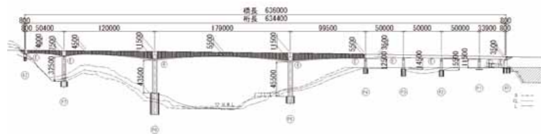
図-8 安威川橋(下り線)(波形鋼板ウェブ橋)
