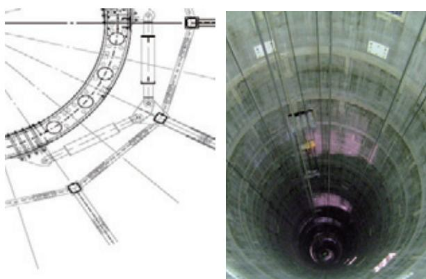
図-1 高層階心柱断面(SWPR7BL 15.2Φ-168本)
