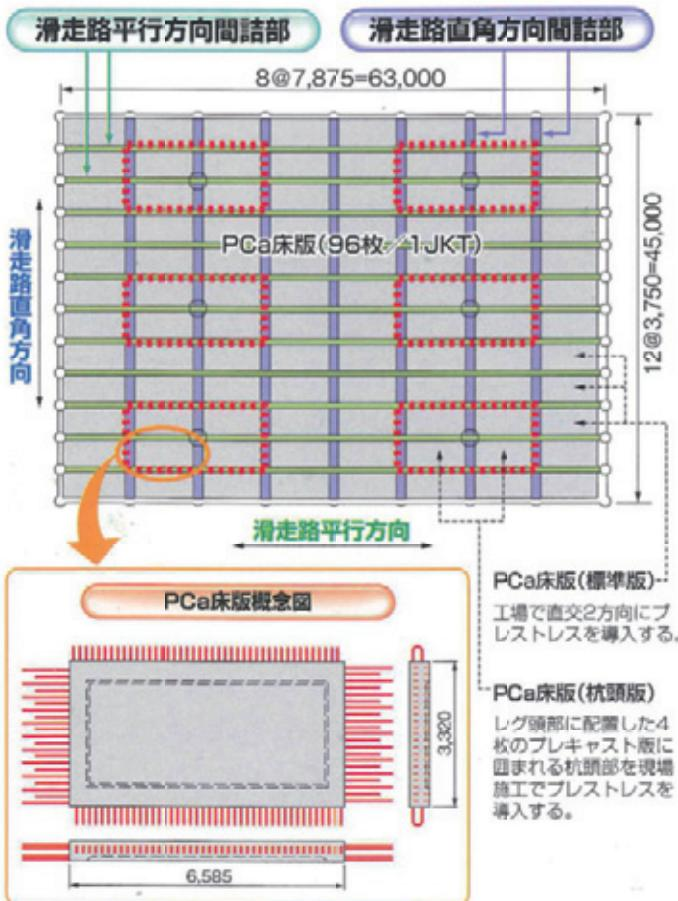
図-3 PCa床版設置概念図
