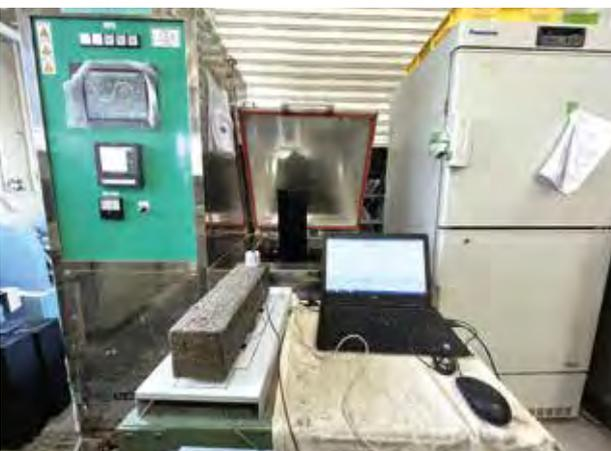
▲写真3 凍結融解試験の様子
