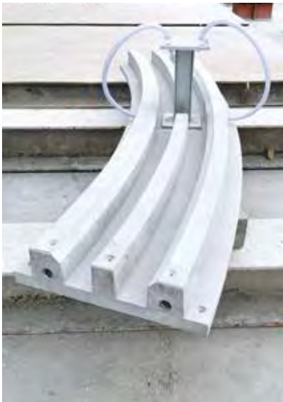
▲写真-2 脱型状況
