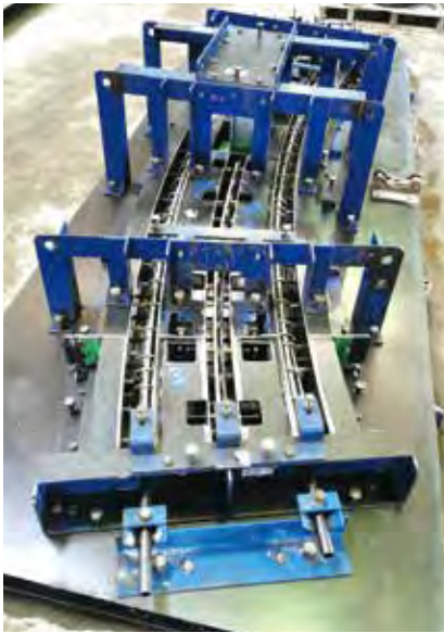
▲写真-1 型枠組立状況
