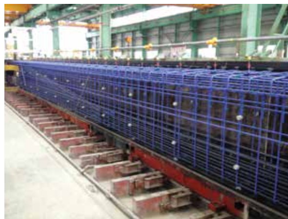
▲ エポキシ樹脂で被覆したPC鋼材と鉄筋を使用したプレテンションT桁
