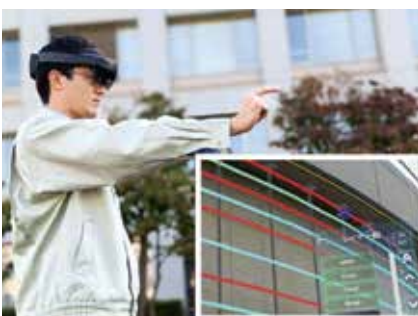
▲ MR技術 ゴーグル越しに見えているPC鋼材配置図
